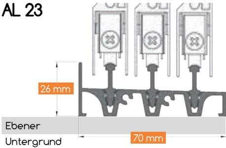
Separate Führungsleisten für das Bodenprofil der AL23 ermöglichen eine exakte Aufnahme der Schiebeelemente, wodurch sich weder Schmutz noch andere Partikel auf den Rollenlauf setzen können. Die konstruktive Schräge gewährleistet zudem den Wasserablauf von der Führungsschiene.
