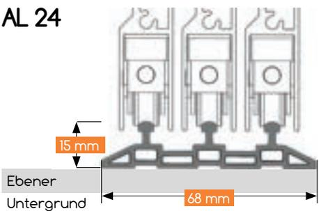
Die untere Führungsschiene der AL24 mit integrierten Stegen verspricht einen leichtgängigen Rollenlauf der Glaselemente und stabilisiert das Profil zusätzlich.
