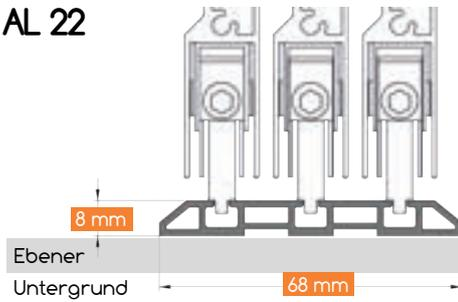
Durch die spezielle Rollenaufnahme der Schiebeelemente hat die AL22 am Boden eine extra flache Führungsschiene für eine nahezu ebene Übergangsschwelle.
