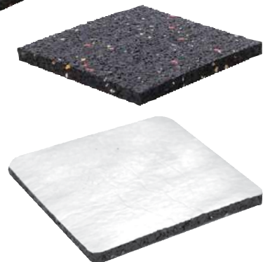
GS Gummigranulatpad CLEVER STOP mit Aluminium Folie kaschierter Unterseite, verhindert die Weichmachermigration zwischen nicht gummiartigen Abdichtfolien (z. B. Weich-PVC) und der Schutzschicht.
