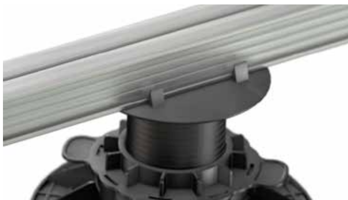
GS Gummigranulatpad CLEVER STOP mit Aluminium Folie kaschierter Unterseite, verhindert die Weichmachermigration zwischen nicht gummiartigen Abdichtfolien (z. B. Weich-PVC) und der Schutzschicht.
