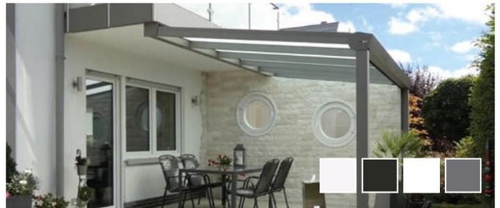
PRIMELINE, variable Dachneigung 5-15°, optionale Rinnenblende (rund, klassik), Wasserablauf unsichtbar im Pfosten integriert, Sondermaße möglich, Dacheindeckungen: Polycarbonat 16 mm oder 8 mm Glaseindeckung (VSG), Rinne und Wandanschluss aus einem Stück (bis 7,95 m Breite),
